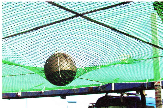
Test: kula o wadze 100 kg zrzucona na siatkę z wysokości 3 m.
