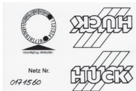
plakietka kontrolna z numerem identyfikacyjnym i następnym terminem badania 4
