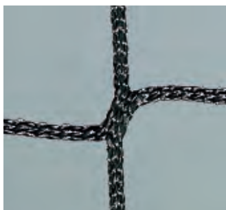
Nr 209 Polipropylen o dużej wytrzymałości, bezwęzłowy, \varnothing ok. 3,0 mm, kolor: czarny
