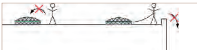
Jak na obrazku nr 1, ale przy zabezpieczeniu siatką i sprzętem SOI.
